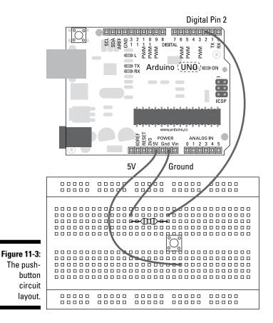
Vin D13 3V3 5V Power **RST** D12 PWM **AREF** D11 10 REF Arduino PWM D10 PWM N/C D9 D8 Digital Input/Output D7 D6 PWM PWM D5 A0 D4 PWM Α1 D3 Figure 11-4: Analog A2 D2 A circuit TX▶ А3 D1 diagram of Α4 RX ◀ D0 the push-10K Ohm Α5 SCL button SDA GND circuit.
