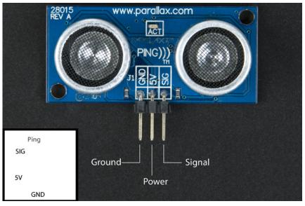
Figure 3-8. The PING))) ultrasonic sensor
